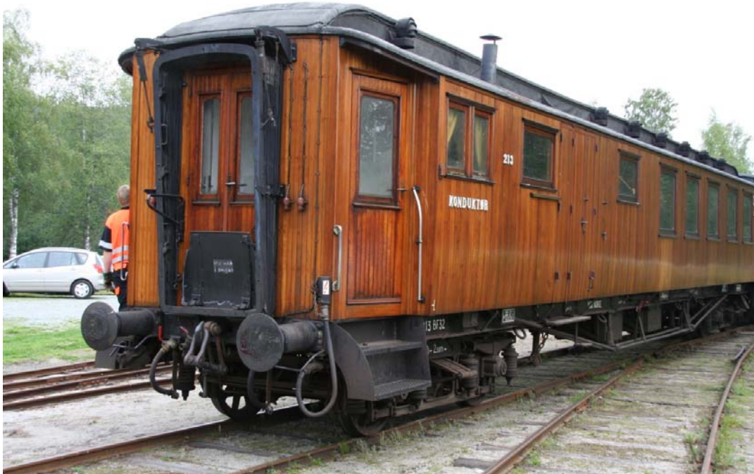
Fig 2. Her ser man detaljene rundt reisegodsdøren. Takrennen og nedløpet ved konduktørvinduet er fjernet ved restaureringen av vognen. Legg også merke til detaljene på belgen. Denne har den nye typen bærejern som kom i 1958. Midt på belgen er det haker til å holde belgen i innslått stilling.
