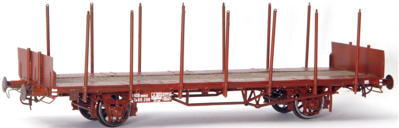
T14I med nedlagte lemmer og trykkluftbremse.
